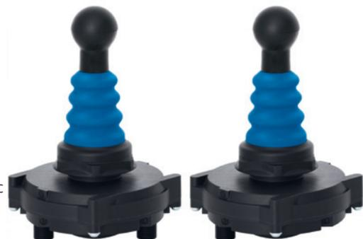
Utilisable de -40°C à +80°C, le montage de ce dispositif est facilité par la présence d'un seul écrou central. La connexion est rapide par connecteur M12, à cinq ou huit contacts. Le manipulateur NK possède 4 directions d'actionnement: avant, arrière, droite et gauche. Enfin, il est aussi disponible pour des applications au standard AS-i (Actuator Sensor-interface).
